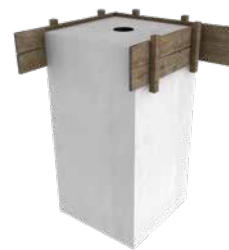
Fundament vor Ort betoniert
