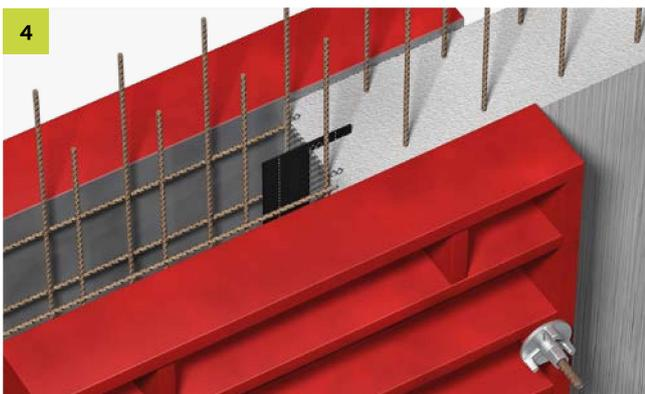
Vor dem Einschalen des zweiten Betonierabschnittes die restliche Schutzfolie des PENTAFLEX® KB entfernen, Bauteil bewehren und Schalung schließen.
