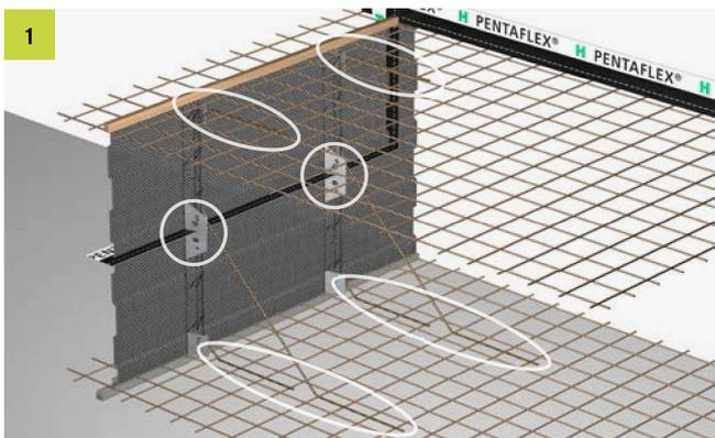
Bei großen Einbauhöhen (z.B. ABS V-S Elemente) das Element mit der Bewehrung verschweißen bzw. mit einer geeigneten Rückverankerung an der Bewehrung befestigen. Die Rückverankerung wird an jedem senkrechten Gitterträger des Elements an drei Punkten (unten/Mitte/oben) empfohlen. Gegebenenfalls Abschalelement gegen den Frischbeton- druck zusätzlich absprießen. Bei Bedarf Lagesicherung des PENTAFLEX® Fugenblechs vorsehen.
