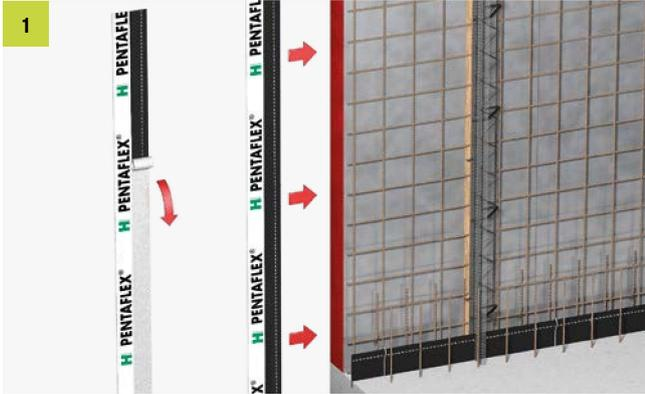
Äußere Schalung stellen und an der Position der Arbeitsfuge Trapezleiste anbringen. Äußere Bewehrung einbringen. WU-taugliche Abstandhalter verwenden! ABS Element über das PENTAFLEX® KB der Boden/Wand-Fuge stellen und mit der Bewehrung verrödeln oder verschweißen. Schutzpapier im Bereich des ersten Betonierabschnittes beidseitig abziehen und das Blech bis zum Anschlag in die Abschalung einstecken.
