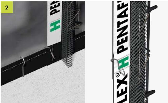
Stöße sind 50 mm zu überlappen. Bei Temperaturen unter +5 °C ist die Stoßstelle zu erwärmen. Anschluss mit Kreuzklammer sichern.
