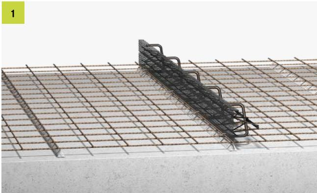
Einlegen eines geeigneten Abstandhalters, Größe  $c_{nom}$ , auf die Sauberkeitsschicht/Schalung an der Stelle, an der die Arbeitsfuge liegen soll (Ebene der Streckmetallbleche). Einbau der ABS-Elemente auf die untere Bewehrungslage. Einbauart so wählen, dass der Gitterträger in den ersten Betonierabschnitt ragt. Befestigung an der unteren Bewehrung mittels Bindedraht. Bei großen Einbauhöhen das Element mit der Bewehrung verschweißen.
