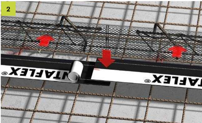
Verlängerung der ABS-Elemente mithilfe von stumpfen Stößen. Folie einseitig oben und unten vom PENTAFLEX® KB Element abziehen und bis zum Anschlag in die Abschalung einschieben. Die Fugenblechstöße sind 50 mm zu überlappen, fest aneinanderzudrücken und mit einer Kreuzklammer zu sichern. Bei Temperaturen unter +5 °C ist die Stoßfläche zu erwärmen.
