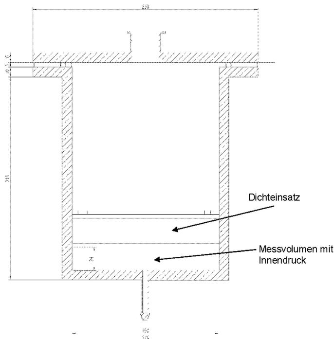
Bild 1: Prüfeinrichtung zur Leckagemessung von Dichteinsätzen
