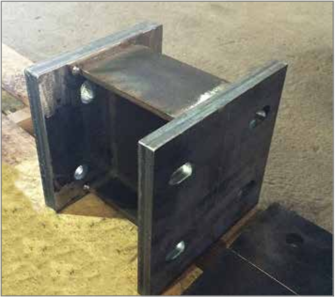
Abb. 36: Adapter mit horizontalen und vertikalen Langlöchern
