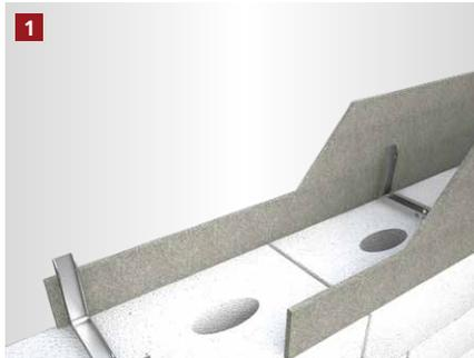
Alle MBA® Ringbalken- und Sturzschalungen sind für die Aufnahme des Steckbügel-systems werkseitig vorbereitet.
