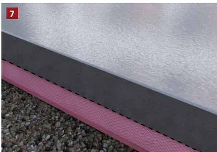
Die Abdichtungsbahn wird auf dem Beton und über dem Systemschenkel FBV bis zur gestrichelten Abdichtungslinie aufgetragen.
