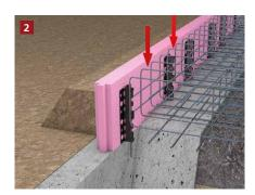
Die Bewehrung für die Bodenplatte wird eingesetzt und die FSA Easy Schalung an den Stabstahlhalterungen in Richtung der Bewehrung abgespannt. Nach Bedarf kann die Schalung von außen angefüllt werden.
