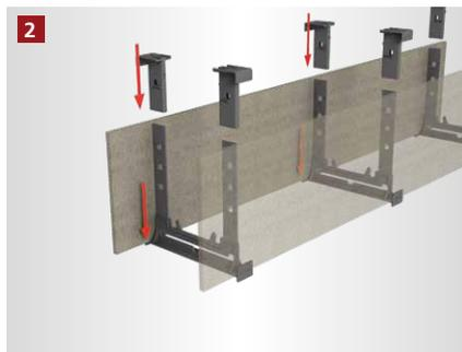
Die Holzbetonschenkel werden in die Einkerbungen des Grundkörpers gesteckt. Die Klemmschieber werden aufgesteckt und verbinden das Element fest miteinander.
